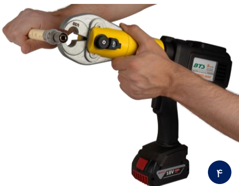
شکل ۵-۱ نحوه پرس اتصالات به وسیله دستگاه پرس BTS
