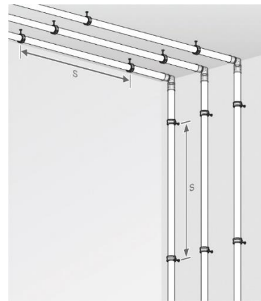
شکل ۲۴-۱ حداکثر فاصله مجاز بین بست‌ها
