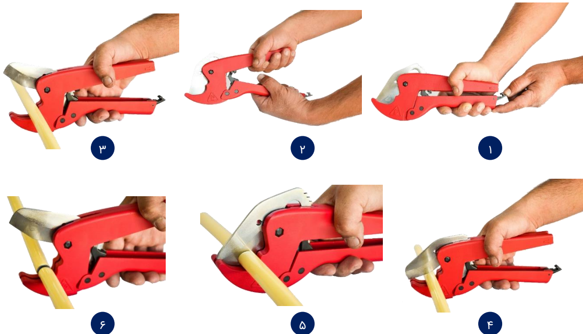
شکل ۷-۱ مراحل انجام برش توسط قیچی برش
