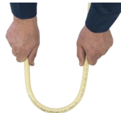
شکل ۲۸-۱ (۱) اجرای خم صحیح با دست (۲) اجرای خم نادرست با دست
