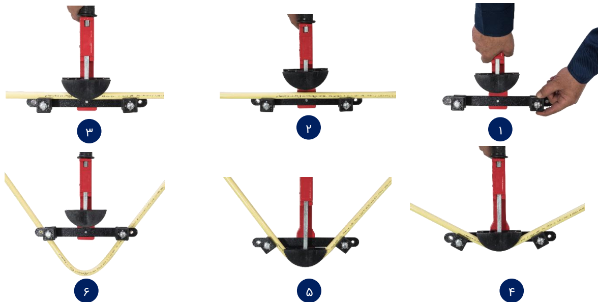
شکل ۱۲-۱ مراحل خم کردن لوله با خم کن
