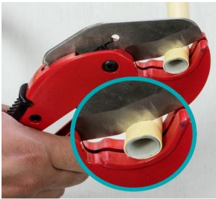
شکل ۲۷-۱ دو پهین شدن لوله در اثر برش ناصحیح
