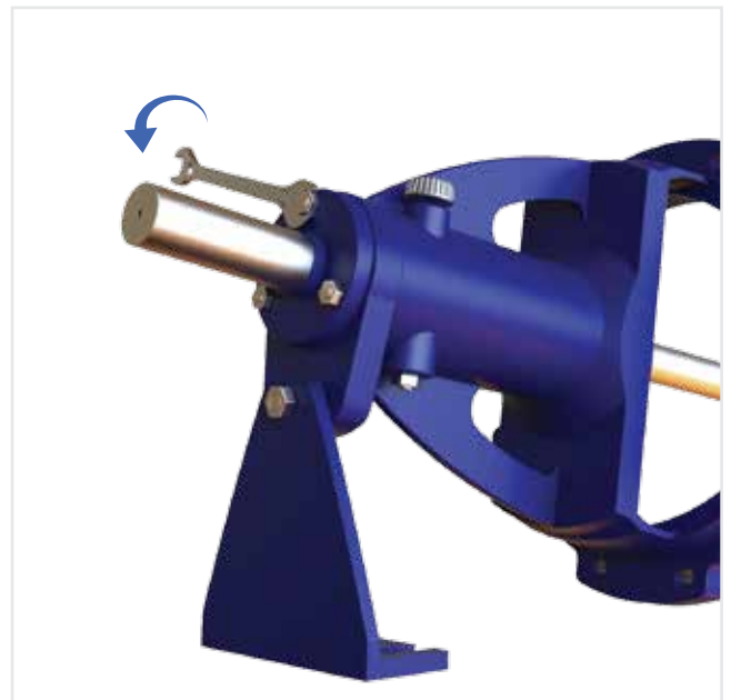
شکل ۲۴- باز کردن درپوش بلبرینگ
