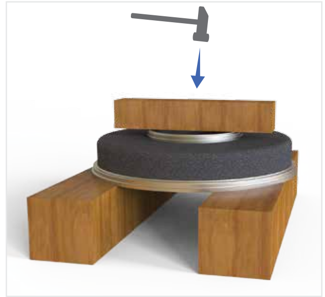
شکل ۲۷- سوار کردن رینگ سایشی
