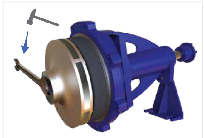
شکل ۲۰- باز کردن مهره شش گوش پروانه
